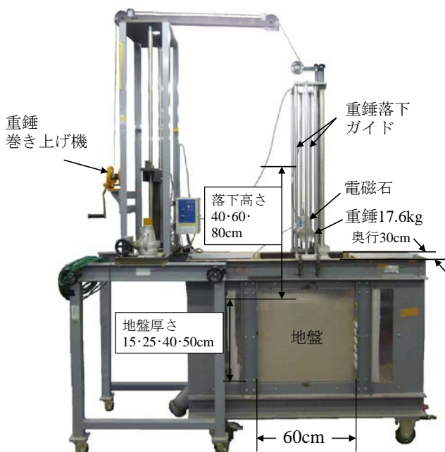
図-1 落下重錘実験装置
